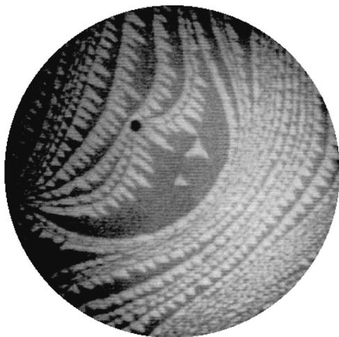
**Рис. 6.11.** Светлопольное изображение фазового перехода Si(111)  $7 \times 7 \leftrightarrow 1 \times 1$  в микроскопе медленных электронов. Фаза  $7 \times 7$  (светлые участки) декорируют атомные ступени в ходе фазового перехода, тогда как поверхность террас в основном покрыта структурой  $1 \times 1$  (темные участки). Контраст обусловлен различием структурного фактора рефлекса (0,0) для двух фаз. Размер поля изображения 5 мкм [6.7]
