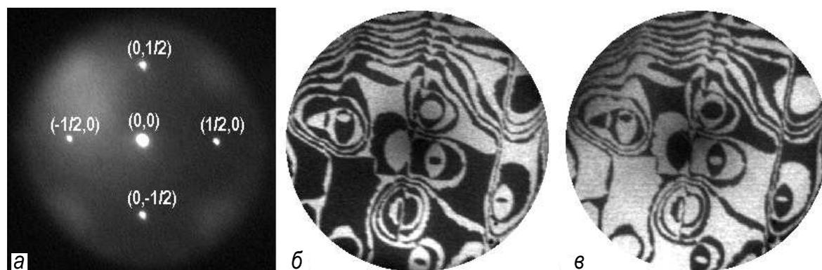
**Рис. 6.12.** *a* – Картина ДМЭ чистой поверхности  $\text{Si}(100)2 \times 1$ . *б* – Темнопольное изображение поверхности в микроскопе медленных электронов в свете рефлексов  $(1/2,0)$  или  $(-1/2,0)$ . *в* – Та же поверхность, что и на рис. *б* в свете рефлексов  $(0,1/2)$  или  $(0,-1/2)$ . Размер поля изображения 5 мкм [6.8]
